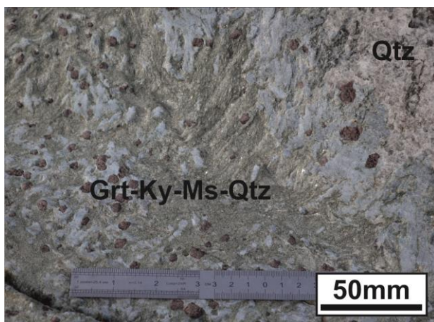
Рис. 3.3.10. Продукты кислотного метасоматоза кyanит-кварцевой и мусковит-кварцевой фаций. Qtz линза характеризует поздние гидротермальные процессы.
