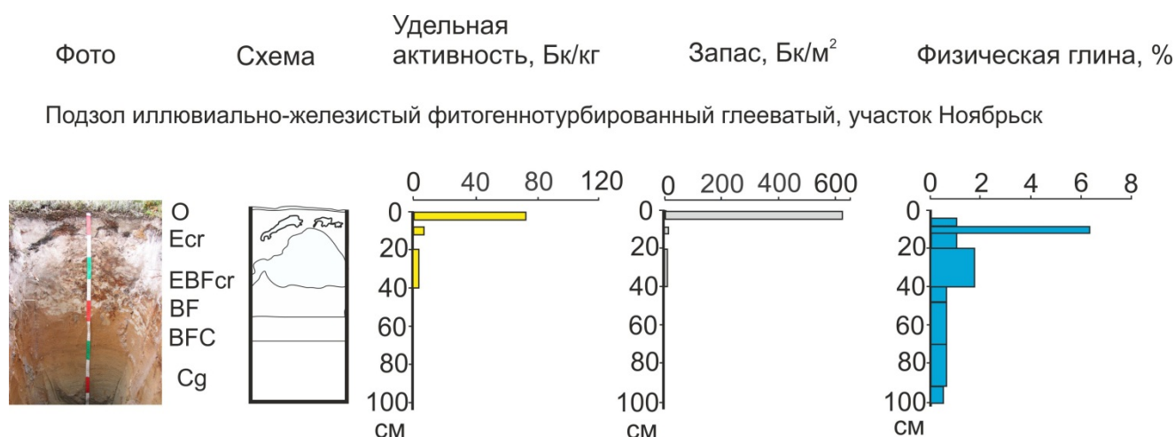
Рис. 3.3. Вертикальное распределение ^{137}\text{Cs} (аккумулятивно-элювиально-иллювиальный тип) в турбированном подзоле и гранулометрический состав, разрез Н13
