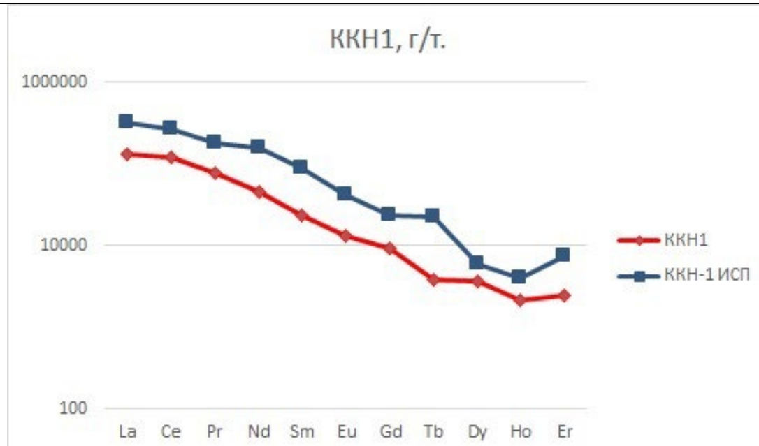
Рисунок 2. Нормированные на карбонатный хондрит спектры содержаний РЗЭ в образце ККН-1, полученные методами ИСП-АЭС и ДДП-АЭС.
