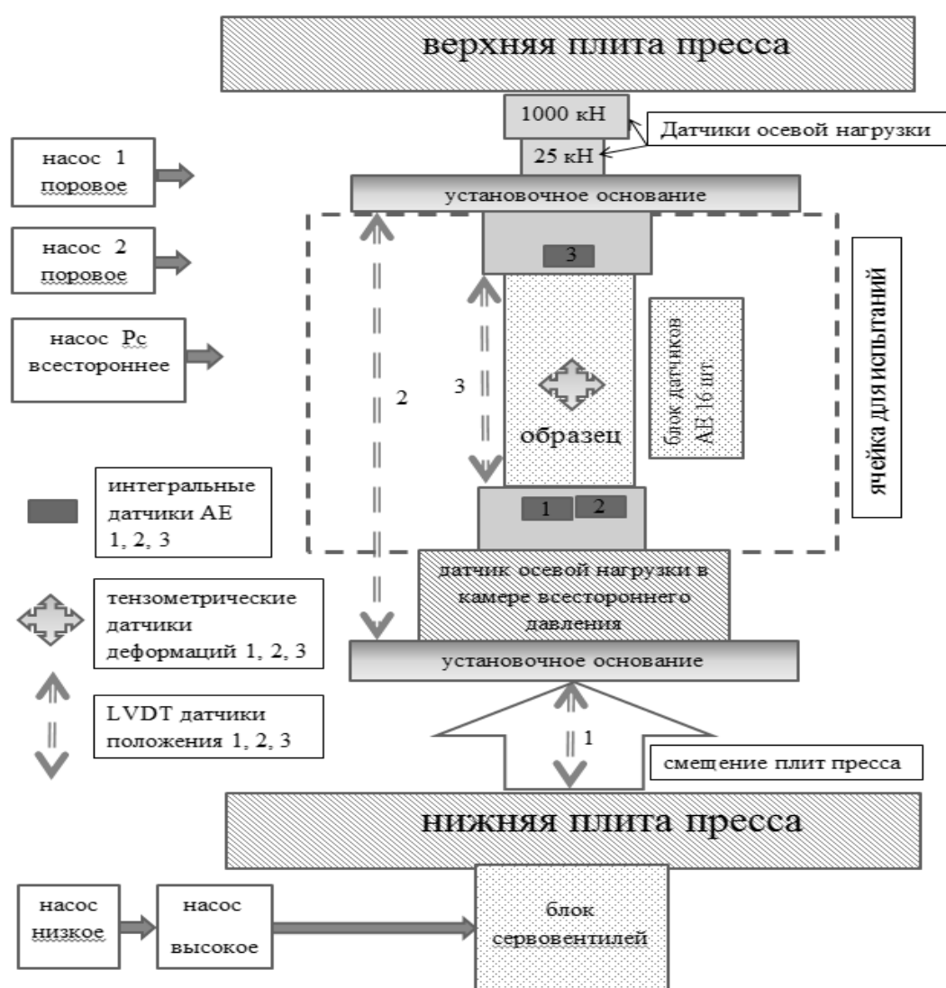
Рис.1 Общая блок схема аппаратно-программного испытательного комплекса на базе пресса ИНОВА.
